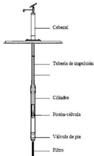
Figura 9. Partes de una bomba manual. Fuente: Cepis (2004)
